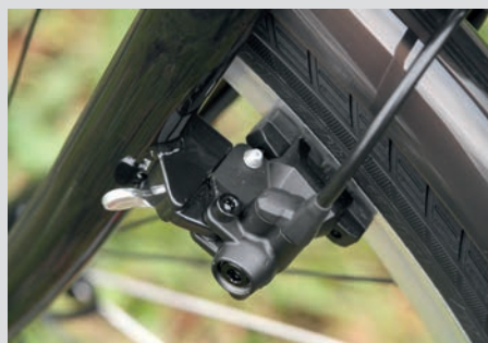
Blijft dé referentie als het gaat om velgremmen: de hydraulische Magura FirmTech. Krachtig, goed te doseren en onderhoudsvriendelijk.
